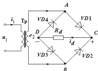
А: двухполупериодного мостового; Б: двухполупериодного с выводом средней точки обмотки трансформатора; В: однополупериодного; Г: трехфазного однополупериодного. Ответ: А
